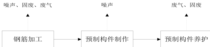
图 3.7.1-7 预制构件工艺流程及产污节点图
